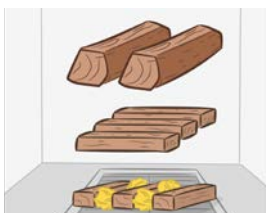
1. Luftzufuhr öffnen 2. Befeuerelement unter dem Scheitholz positioniert 3. Zündmittel entzünden
