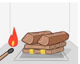
1. Luftzufuhr öffnen 2. Befeuerelement unter dem Scheitholz positioniert 3. Zündmittel entzünden
