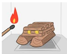
1. Luftzufuhr öffnen 2. Befeuerelement auf dem Scheitholz positioniert 3. Zündmittel entzünden
